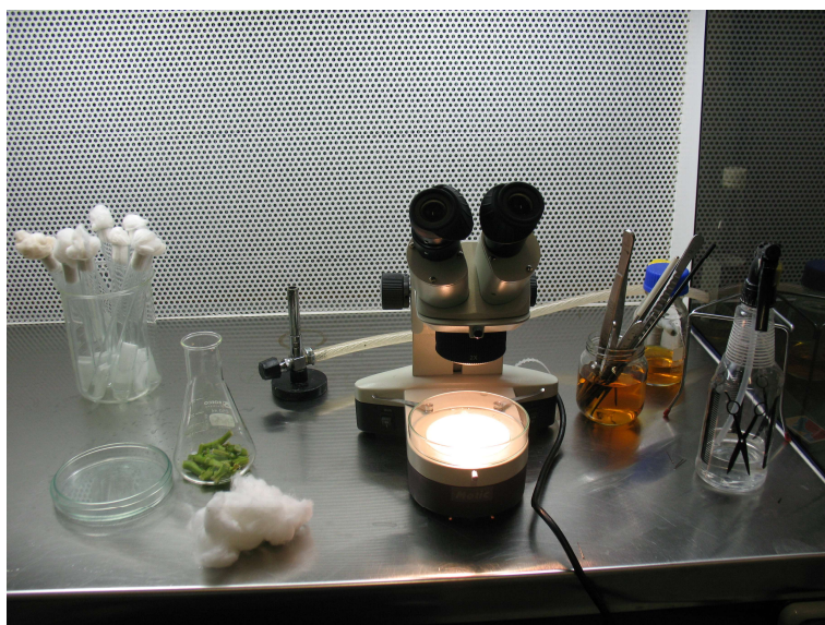
شکل ۲- وسایل مورد نیاز برای کشت مریستم در زیر هود آزمایشگاهی
